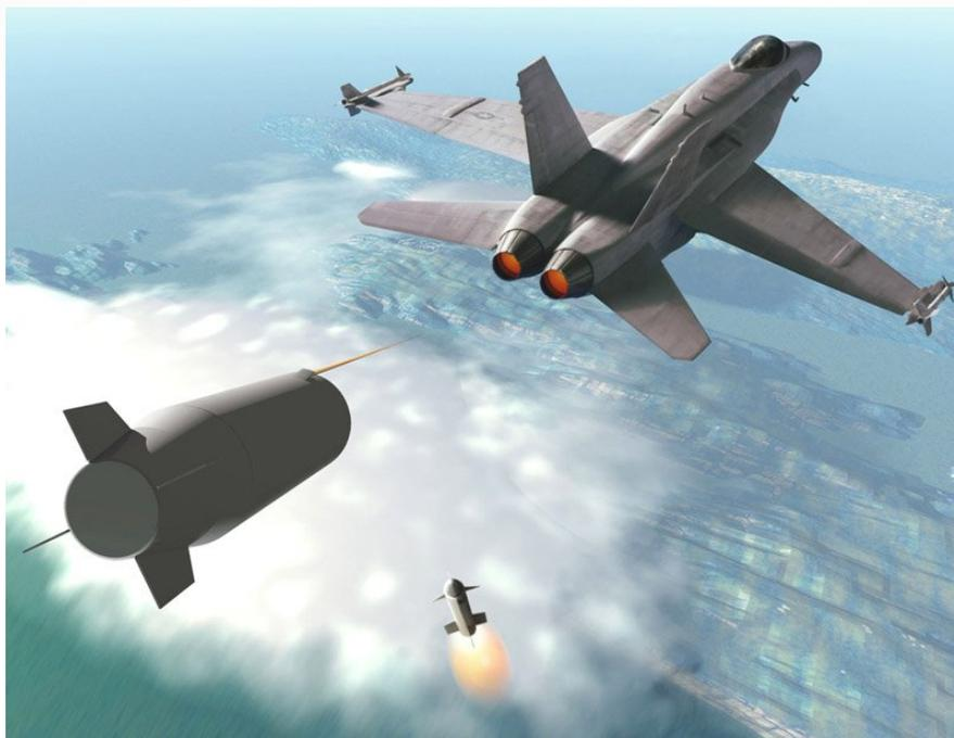
**Принцип действия:** БРЛ используются для создания и излучения сигналов, аналогичных по структуре сигналам, отраженным от защищаемых самолетов, и превосходящих их по мощности. В таких условиях РГС атакующей ЗУР, принимая оба сигнала, наводится на их энергетический центр. При этом поражение ракетой самого самолета практически исключается.
